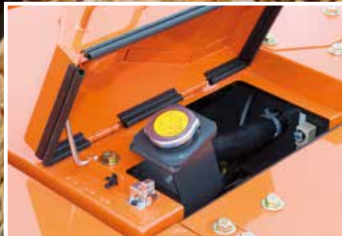
El depósito de expansión impide que las piezas del motor se calienten.
