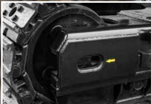
El protector del motor y el soporte de la rueda guía reforzados protegen frente a daños.
