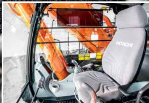
La disminución de los puntos ciegos mejora la visibilidad.
