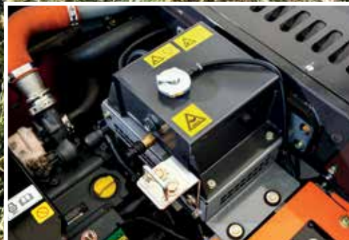
Expanzní nádržka zabraňuje přehřívání součástí motoru.
