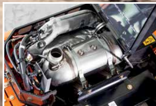
Systém SCR snižuje emise a hladinu hluku.
