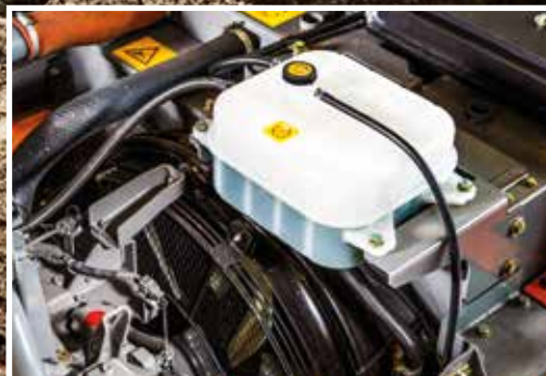
Il vaso di espansione impedisce ai componenti del motore di surriscaldarsi.
