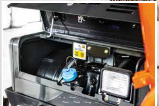
L'urea è introdotta nei gas di scarico per ridurre le emissioni.
