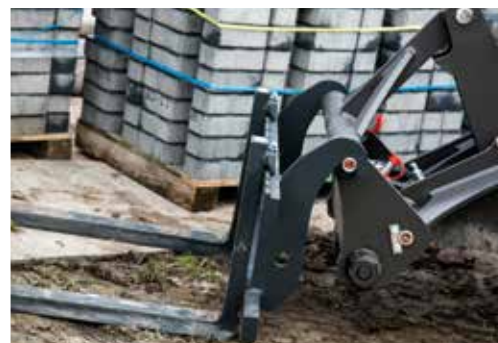
Osprzęt jest łatwo i bezpiecznie montowany przy użyciu szybkozłącza.
