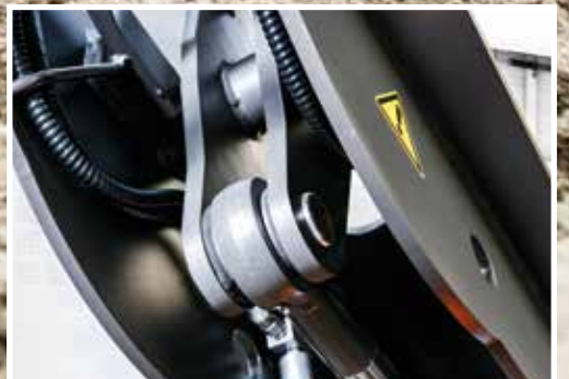
Umieszczenie przewodów i okablowania na wewnętrznej stronie pojedynczego ramienia pozwala chronić najważniejsze podzespoły.
