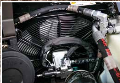
Wentylator silnika pomaga zredukować poziom emisji spalin i zmniejszyć zużycie paliwa.
