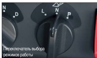
Режим P: Тяжелые землеройно-транспортные работы Режим N: Погрузка Режим L: Работы легкого типа
