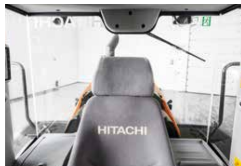
Změny konstrukce vedly ke zlepšení výhledu směrem dozadu.
