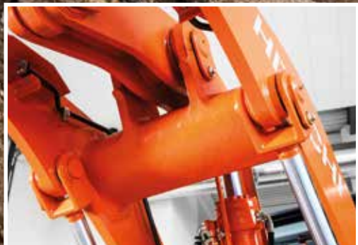
Zvýšená pevnost zvedacího ramena.
