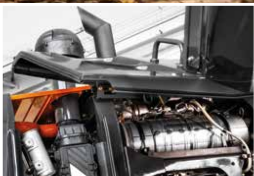
Systém SCR slouží ke snížení emisí.
