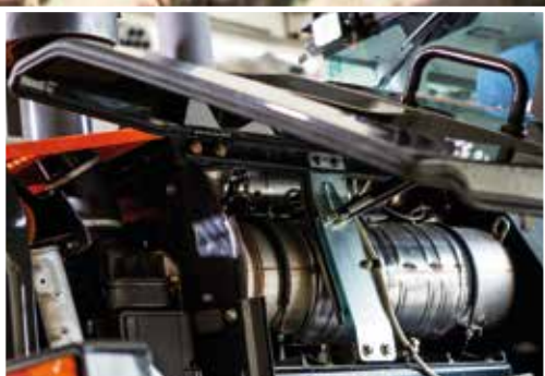
Systém SCR snižuje hladiny emisí a hluku
