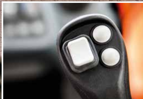
Tlačítkem pracovního režimu P lze v případě potřeby zvýšit výkon.
