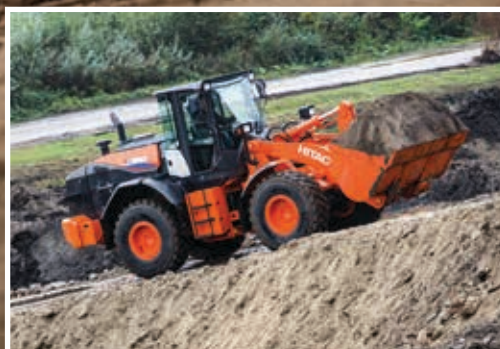
Funkcja automatycznego zwiększania mocy zwiększa osiągi podczas jazdy pod górę.
