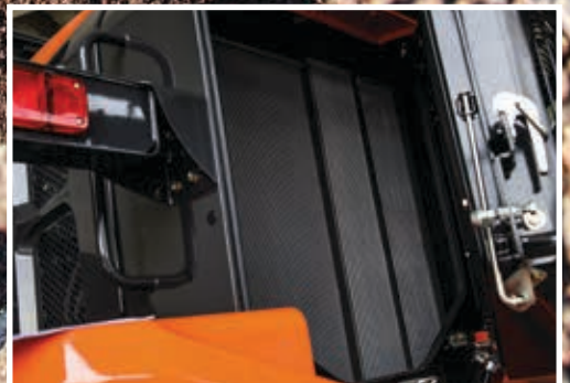
Opcjonalne niezapychające się chłodnice zwiększają wytrzymałość.
