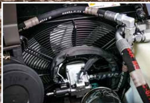
Le ventilateur de refroidissement du moteur contribue à réduire les émissions et à améliorer le rendement énergétique.
