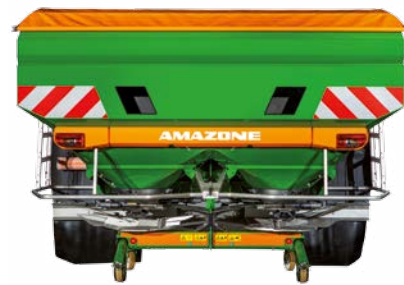
Aufsatz L 4200 (Einfüllbreite 2,71 m) mit klappbaren Leitern
