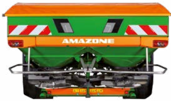
Aufsatz S 2000 (Einfüllbreite 2,22 m)
