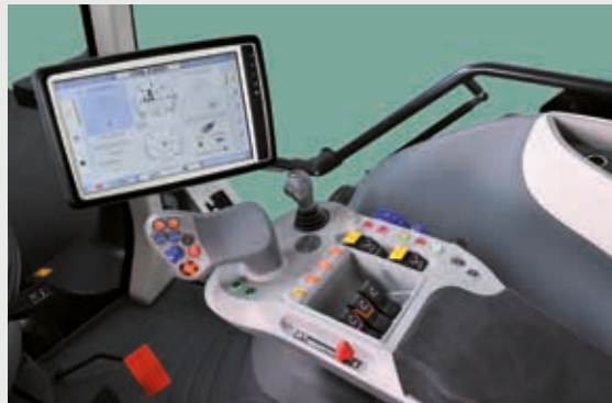
Kabine mit Premium -Ausstattung: Die Bedienelemente des P6-Drive-Getriebes sind an der Armlehne angeordnet.
