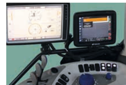
Il monitor touch screen di 8.4" dedicato alla gestione della guida satellitare e del sistema Isobus per le attrezzature.
