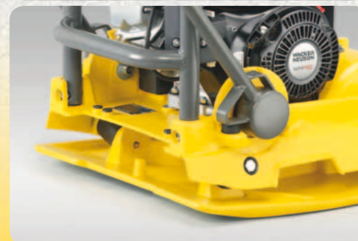
Krawędzie płyty wykonane pod skosem ułatwiają miejscowe zagęszczanie.
