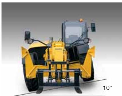
*La nivelación de bastidor opcional mantiene el portaequipos en posición horizontal sean cuales sean las condiciones del terreno. Alcanza ángulos de 10° por ambos lados e incrementa la flexibilidad y la capacidad de elevación.*
