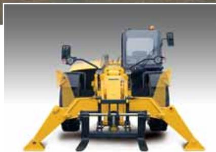
*Los estabilizadores de tipo ancho opcionales garantizan la máxima estabilidad en cualquier tipo de terreno. Los cilindros quedan perfectamente protegidos dentro del bastidor.*
