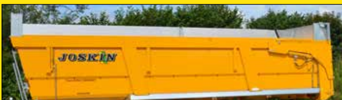
Combinación de realces de alu y de un realce hidráulico de acero (50 cm)
