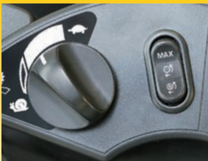
Stufenlose Geschwindigkeitsregelung mit neuer variabler Kriechganggeschwindigkeit (links) und Schalter für einstellbares Zugkraftkontrollsystem (rechts)
