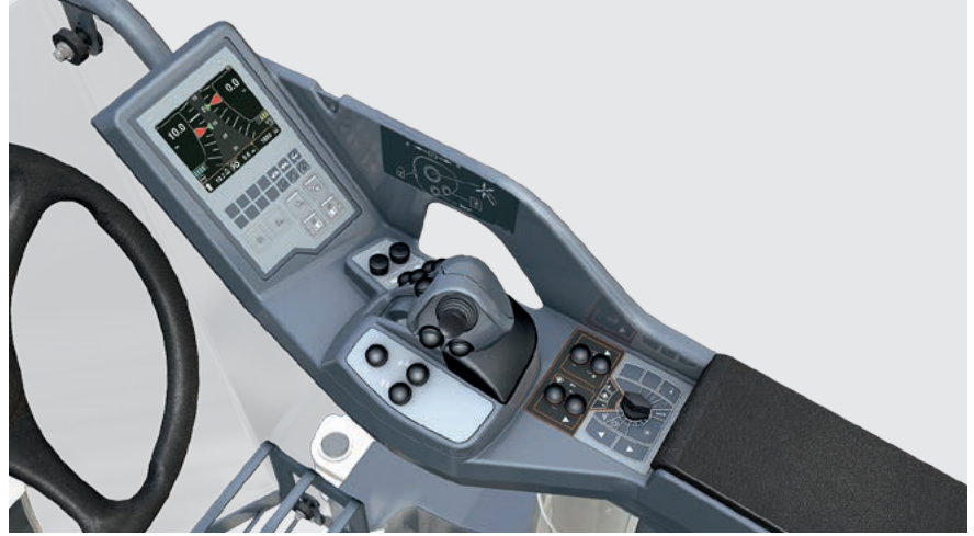
Regulación de la altura de la máquina mediante el reposabrazos multifuncional.
