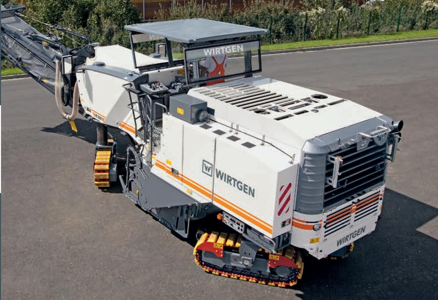
*Verblüffend kleine Wendekreise durch weite Einschlagwinkel aller Kettenlaufwerke.*
