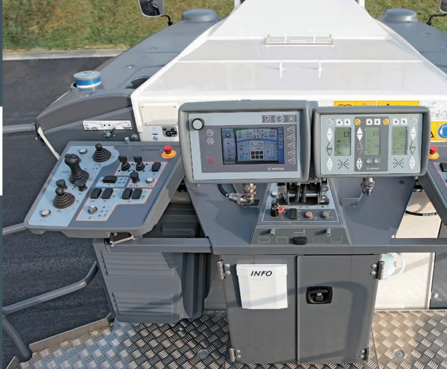
*Der Arbeitsplatz ist links und rechts mit funktionsgleichen Bedienpulten ausgestattet.*
