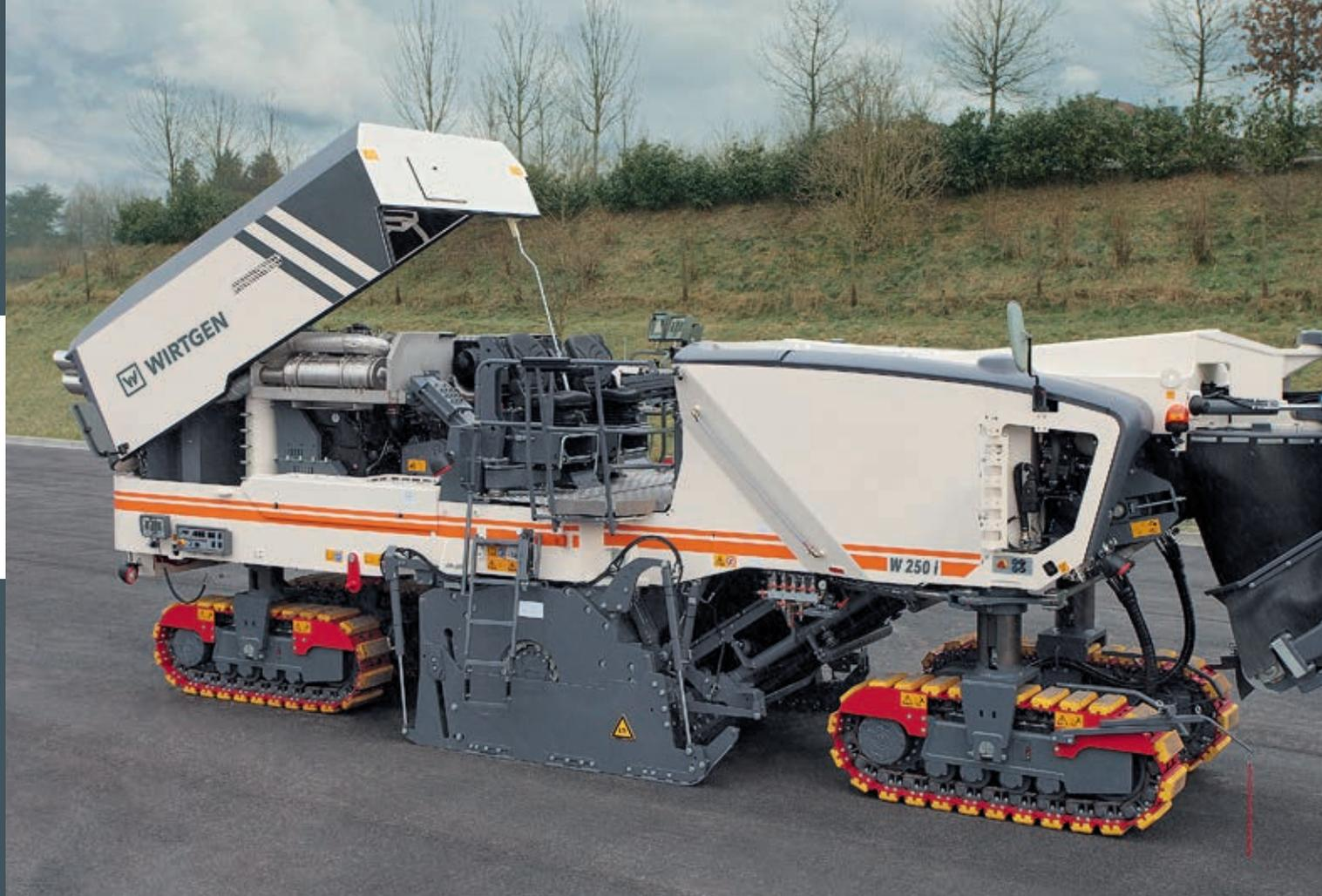
*Ouverture confortable du capot moteur par commande hydraulique sur une simple pression de touche.*
