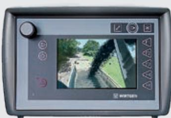
2 | Caméra extrémité du convoyeur
