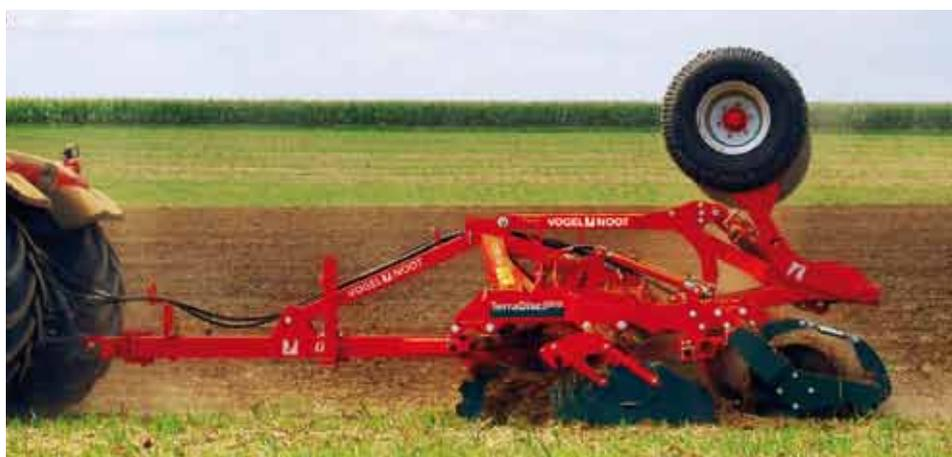
Le TerraDisc<sup>pro</sup> Hydro est disponible en largeurs de travail 4,00, 5,00 et 6,00 mètres avec châssis repliable hydrauliquement, en option également avec châssis semi-porté
