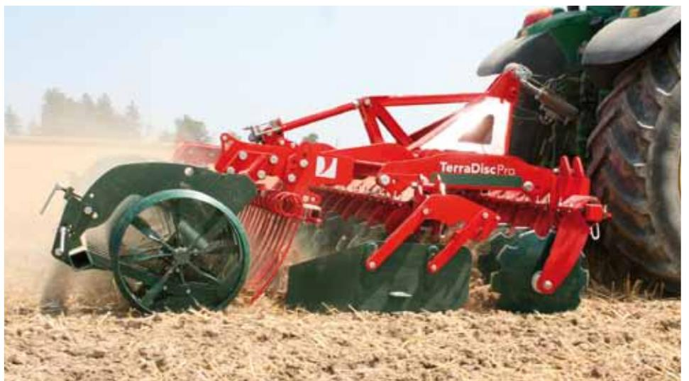
Le TerraDisc<sup>pro</sup> est disponible en largeurs de travail 3,00, 3,50\* et 4,00\* mètres avec châssis rigide
