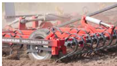
Flexboard hydraulique pour émettre et niveler le sol avant le passage des dents avec plaques d'usure réglables.
