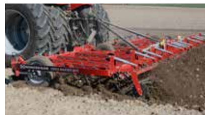
Les 5 rangées de dents permettent, grâce à une implantation symétrique de dents, un flux de terre régulier.
