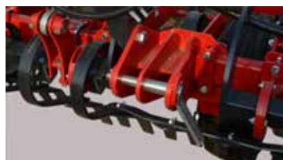
Chappe d'attelage Cat. 2 ou Cat. 3. Les axes sont bloqués en rotation.
