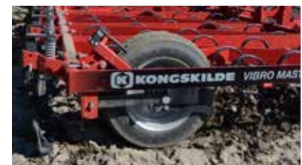
Les 4 roues pneumatiques sont disposées à l'avant des dents, évoluant sur un sol ferme pour un meilleur contrôle de profondeur (24x8.00/14.5)
