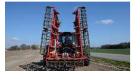
Repliage vertical au transport, largeur 3.00 m.
