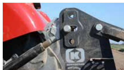
L'attelage sur le trou oblong du 3ème point permet un meilleur suivi du sol et réduit les efforts sur l'attelage.
