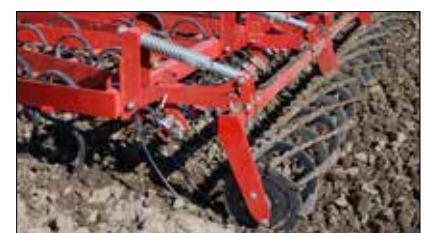
Réglage indépendant de la pression et l'angle d'attaque des équipements arrière.
