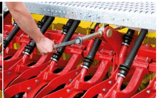
Regulación de presión de discos centralizada – hasta 50 kg
