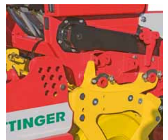
En transporte colocar nuevamente los pasadores para asegurar Sembradora.
