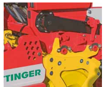
Fixierbügel aufstecken und Sämaschine sichern
