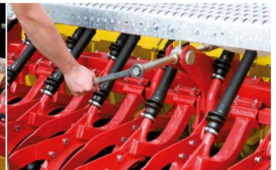
Zentrale Schardruckverstellung – bis zu 50 kg Schardruck
