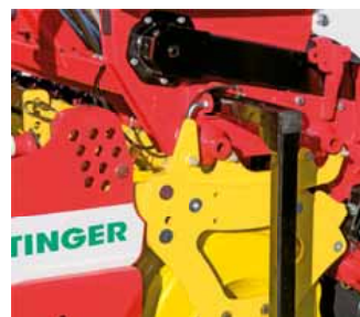
Unter Sämaschine fahren – Kreiselegge anheben
