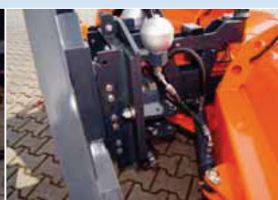
hydraulische Verstellung der Klappflügel
