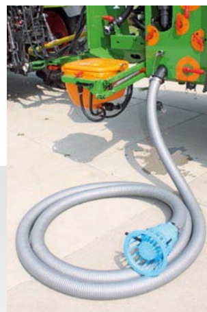
Enchimento através de mangueira de sucção
