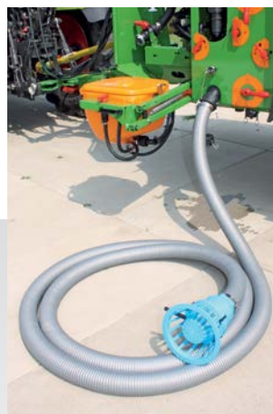
Remplissage par flexible d'aspiration
