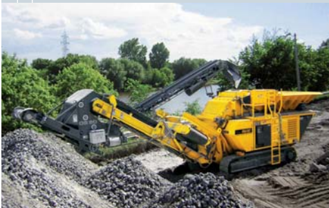
Definiertes Endkorn in einem Arbeitsgang mit nur einem Betreiber im geschlossenen Kreislauf
