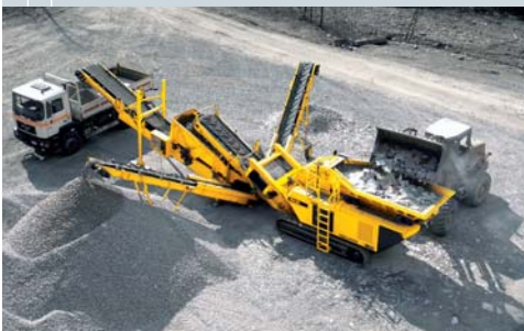
Hohe Trennschärfe selbst bei maximalem Durchsatz und Effizienz dank selbstreinigender Siebdecks
