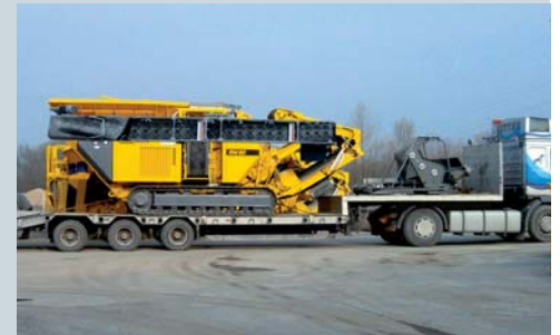
Gewinn durch Mobilität: Brecher und OS80 samt Rückführband kommen mit nur einem Transport
