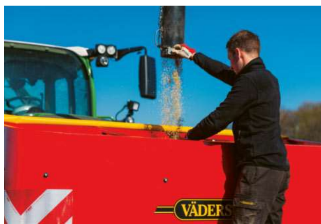
Sklánějící se konstrukce přední části poskytuje řidiči dobrý výhled. Velký otvor a vestavěný schůdek usnadňují plnění.
