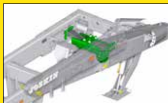
Zawieszenie dyszla z resorami parabolicznymi
