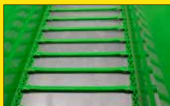
Łańcuchy ogniwowe - przenośnik przykręcany
