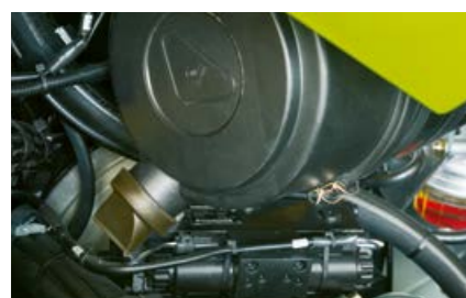
Filtr wstępny niezawodnie usuwa zanieczyszczenia z filtra powietrza.
