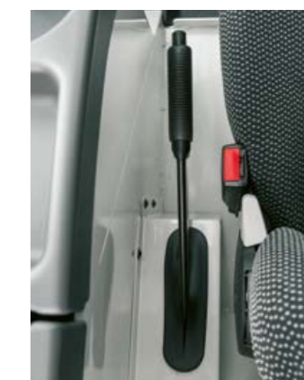
Mechaniczny hamulec postojowy z lewej strony obok fotela operatora
