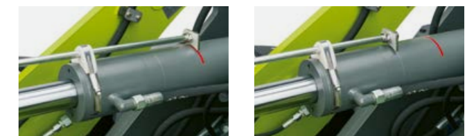
Mechaniczny wskaźnik nachylenia zapewnia stałą kontrolę nad kątem narzędzia roboczego.
