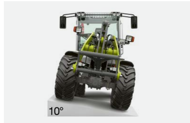
Solidny przegub łamany o kącie wychylenia wynoszącym 10° kompensuje nierówności podłoża, zapewniając wysoką stabilność i komfort jazdy.
