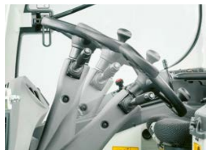
Kolumna kierownicy z bezstopniową regulacją wysokości i nachylenia
