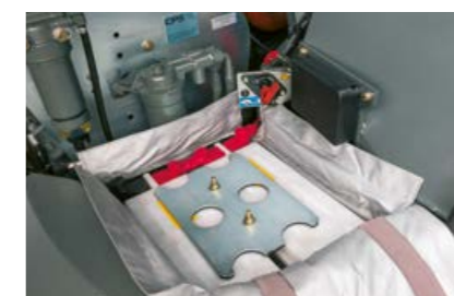
Akumulator i główny włącznik TORION 1511–1177 są łatwo dostępne.
