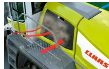
Powierzchnie zasysania i chłodnica są wolne od kurzu i zanieczyszczeń
