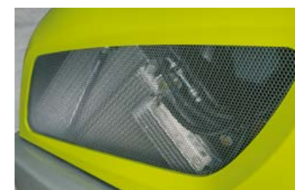
Duża powierzchnia zasysania powietrza w pakiecie chłodnic
