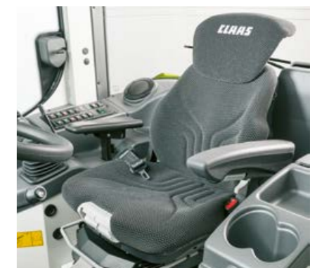
Ogrzewany fotel z amortyzacją pneumatyczną i wysokim oparciem pleców
