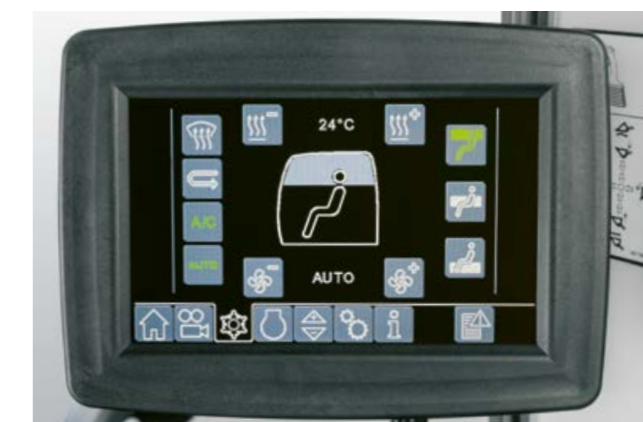
Sterowanie klimatyzacją odbywa się na klawiaturze lub wyświetlaczu dotykowym.
