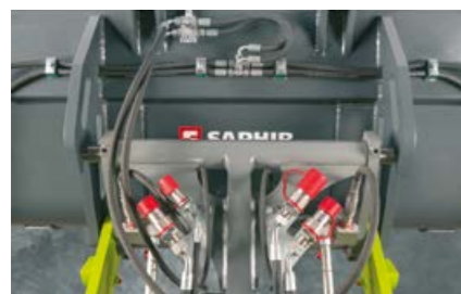
Wszystkie połączenia hydrauliczne są łatwo dostępne, a jednocześnie chronione na uchwycie narzędzi.
