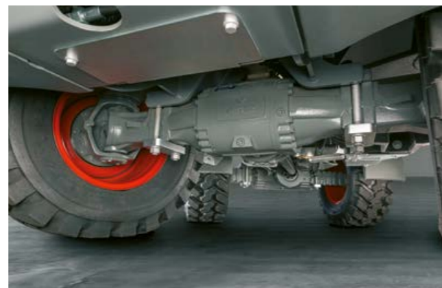
Gdy tylko operator skręci ładowarkę kołową, oś tylna również skręca synchronicznie.
