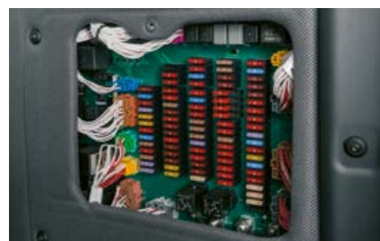
Centrala elektryczna w chronionym schowku.
