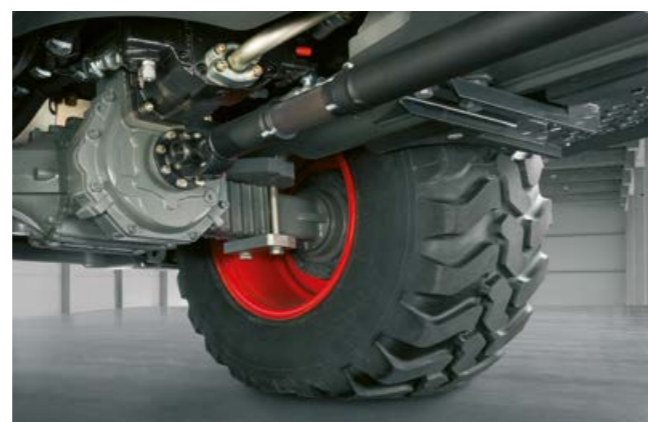
Przekładnia hydrostatyczna z samoczynnym hamowaniem
