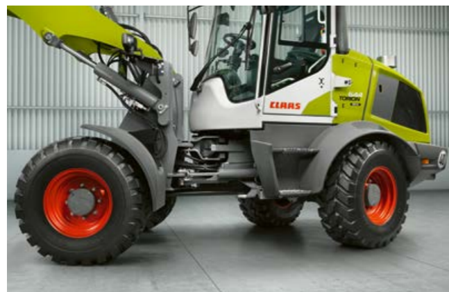
Mimo że TORION mniej się łamie, dzięki kierowanej osi tylnej jest bardziej skrętny i podnosi więcej.
