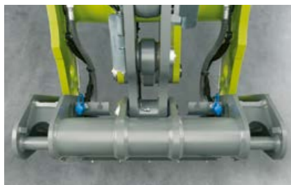
Wszystko przygotowane na bezpieczne zamocowanie dwóch przyłączy hydraulicznych dla kolejnego obwodu sterowania
