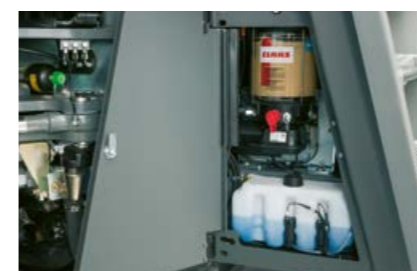
Zbiornik centralnego układu smarowania oraz spryskiwacz szyby są doskonale widoczne w strefie wejściowej.
