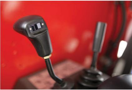
Der FNR Joystick (Forward Neutral Reverse) steuert die Auslegerbewegungen und die Fahrtrichtung des TMT. Der Fahrer plaziert je eine Hand am Lenkrad und am Joystick und erreicht so eine ergonomische, komfortable Arbeitsweise.
