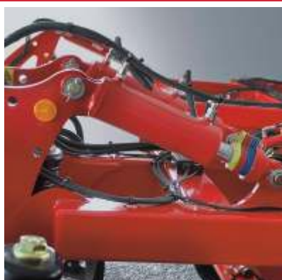
Tiefeneinstellung mit AluClips
