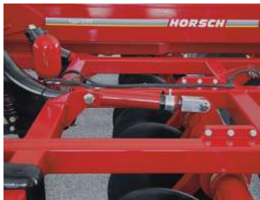
DiscSystem Stufenlose Tiefeneinstellung unabhängig vom Zinkenelement, hydraulische Steinsicherung
