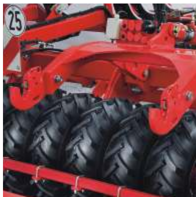
Unterlenker Anbaurahmen mit hydraulischen und elektrischen Anschlüssen
