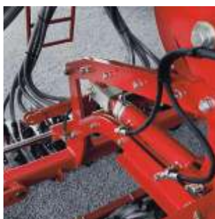
Pronto TD Individuelle Einstellung der Sätiefe mittels AluClips
