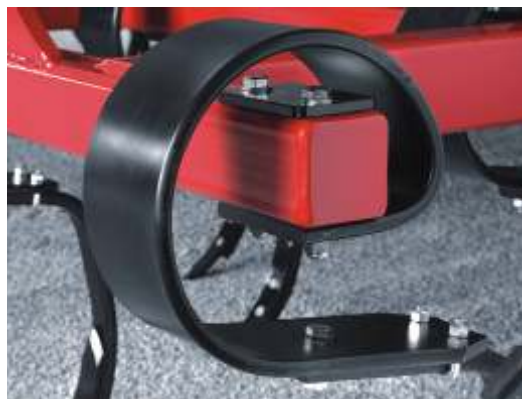
Blattfederzinken Wartungsfrei und geringe Verstopfungs- anfälligkeit durch Vibration
