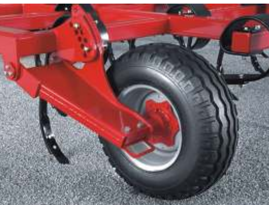
Stützrad Exakte Tiefenführung in allen Arbeitstiefen
