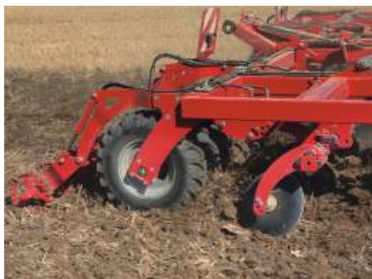
Reifenpacker Effektive und bodenschonende Rückverfestigung in die Tiefe
