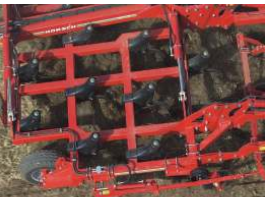
TerraGrip Intensives Mischen und Lockern durch vier Zinkenreihen
