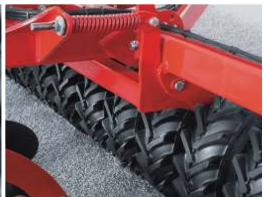
Robuster Reifenpacker Reifenpacker mit optimiertem AS Profil. Gefedertes Mittelsegment dient als Fahrwerk zum Straßentransport.
