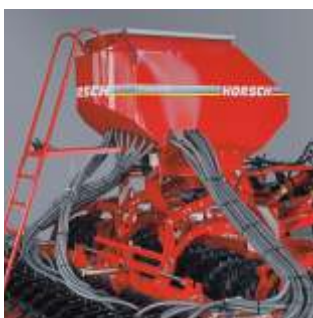
Pronto TD 2.000 l Saattank Inhalt, Dosiergerät, Gebläse
