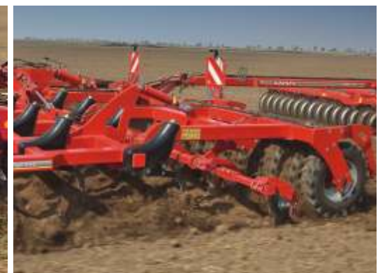
Einebungsscheiben Gleichmäßige Einebnung vor dem Reifenpacker
