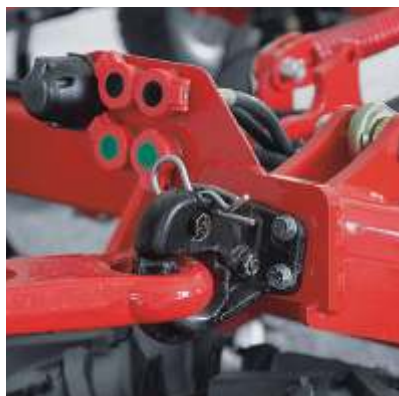
Zugmaul mit hydraulischen und elektrischen Anschlüssen
