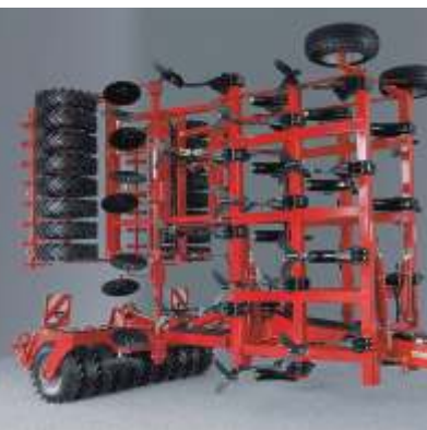
Fahrwerk mit beweglichem Mittelsegment
