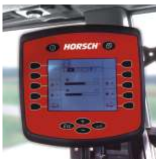
DrillManager Elektronische Sämaschinen- steuerung mit Radarsensor
