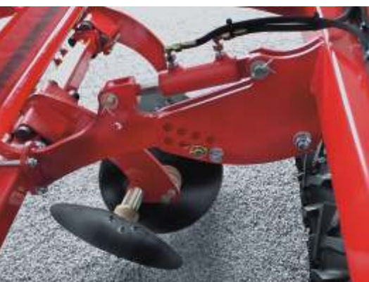
Effektive Scheibenebnung Wartungsfreie, tiefenverstellbare Scheibenelemente. Randscheiben individuell anpassbar.
