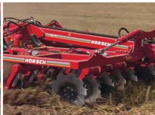
Zweireihiges DiscSystem Schneidet alle Ernterückstände durch
