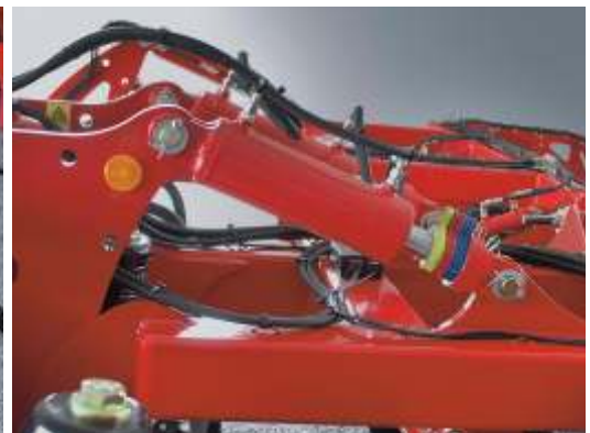
Variable Tiefeneinstellung Mit AluClips kann die Arbeitstiefe einfach eingestellt werden
