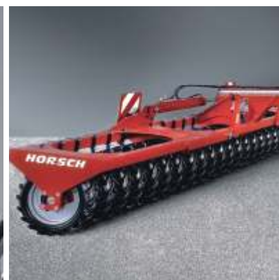
OptiPack AS mit walkfähigem Reifenpacker
