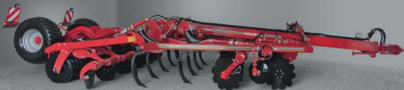
Tiger MT Vierbalkiger Rahmenaufbau, zweireihiges DiscSystem, zweireihiges Zinkenelement, einreihig angeordnete Einebnungsscheiben, Reifenpacker und TopRing Packer
