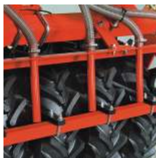
Saatgutausläufe Anordnung mittig vor jedem Packerreifen
