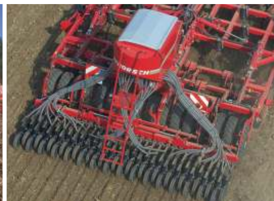
Pronto TD Aufgesattelte Universaldrillmaschine mit TurboDisc Schar
