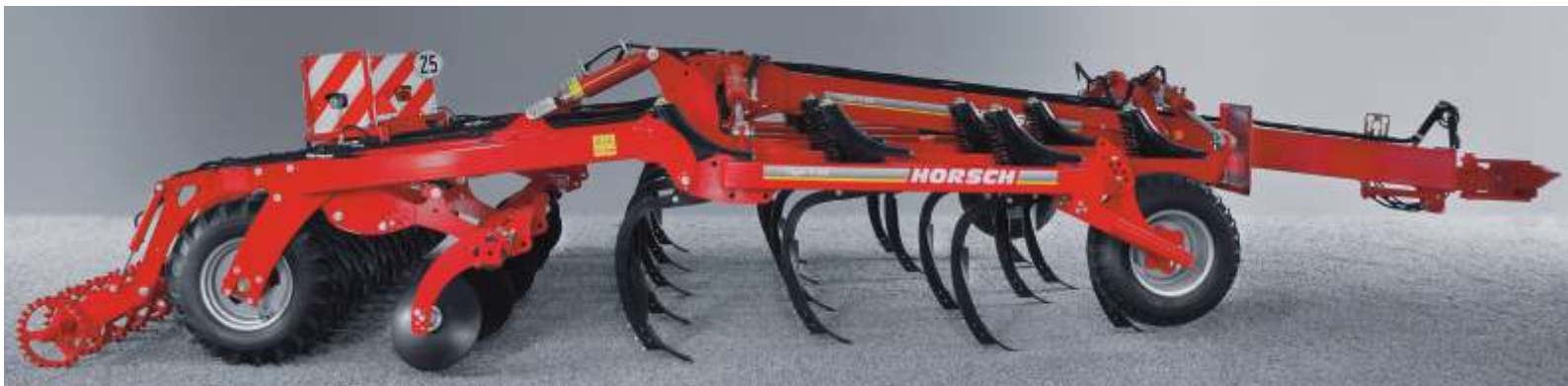
Tiger AS Vierbalkiger Rahmenaufbau, 23 cm Strichabstand, 85 cm Rahmenhöhe, einreihig angeordnete Einebnungsscheiben, Reifenpacker und TopRing Packer
