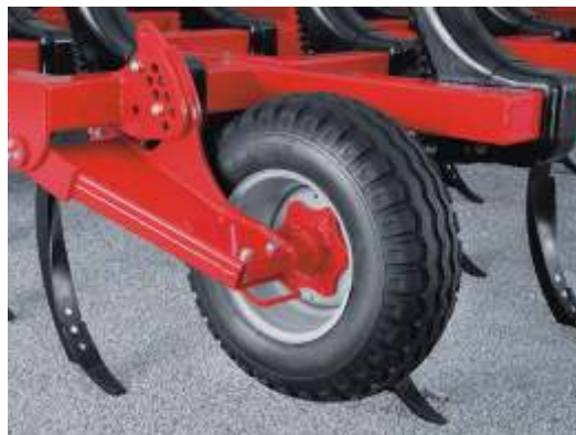
Tastrad Tiefenverstellbares Tastrad sorgt für eine gleichmäßige Arbeitstiefe über die gesamte Arbeitsbreite
