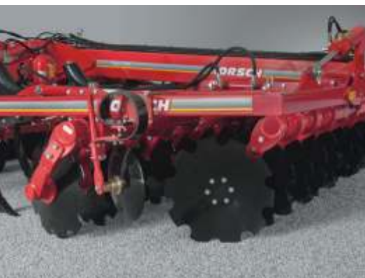
Schweres DiscSystem Zweireihige Anordnung, Scheibendurchmesser 68 cm, Scheibenabstand 40 cm, gezackte Scheiben mit Einzelaufhängung
