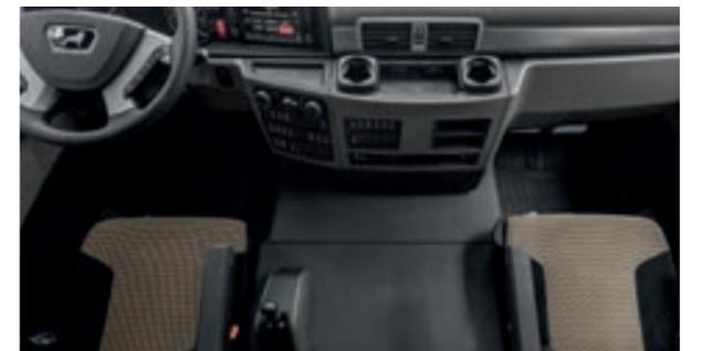
Freiraum durch neue Anordnung von TipMatic-Schalter und Feststellbremse.
