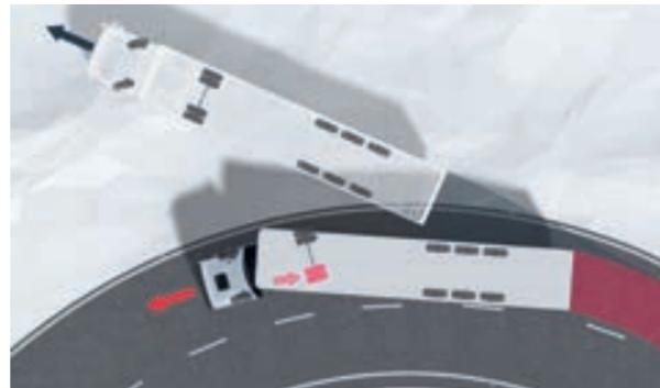
ESP-Ausgleichsbremung beim Untersteuern des Zugfahrzeugs.
