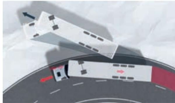
ESP-Ausgleichsbremung beim Übersteuern des Zugfahrzeugs.
