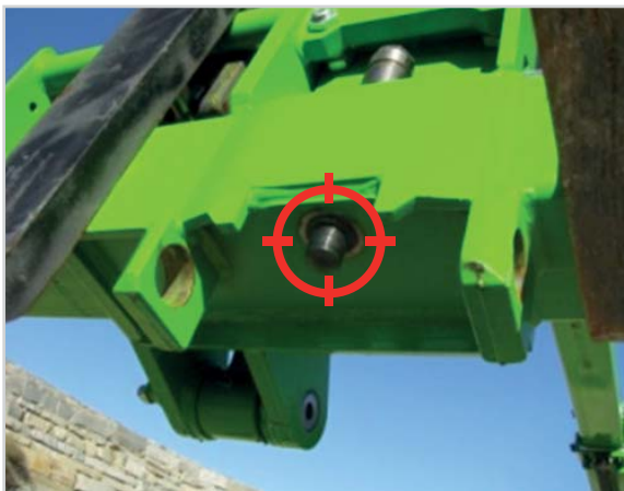
Tac-Lock: hydraulische Befestigung der Anbaugeräte direkt von der Kabine
