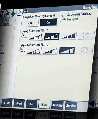
QuickTurn II: adaptacyjny układ kierowniczy (ASC) pozwalający szybciej wykonywać skręty
