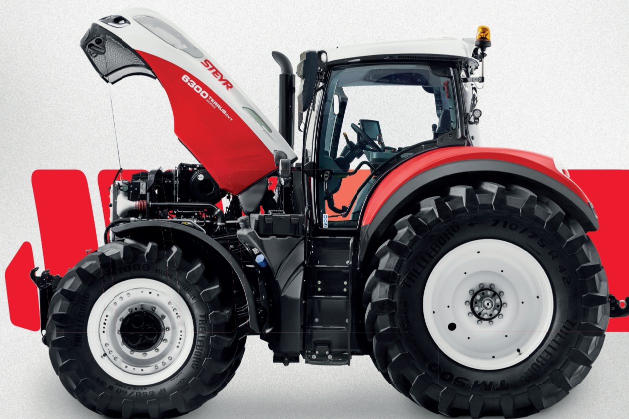
Ciągłe czyszczenie za pomocą filtra Piclon sprawia, iż prace konserwacyjne są wymagane tylko wtedy, gdy zaświeci odpowiednia lampka ostrzegawcza.
