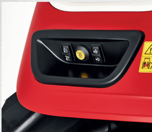
Przyciski do włączania tylnego WOM, tylnego zaczepu i moduł sterujący na każdym błotniku.
