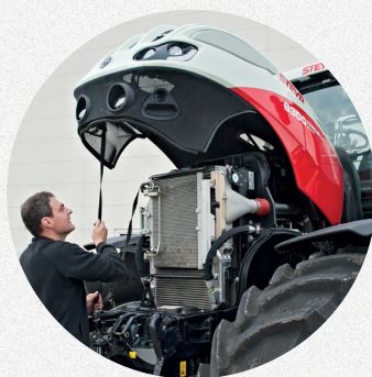
Jednoczęściowa maska silnika ze sprężyną gazową może być unoszona do dwóch pozycji (45°/90°), nawet z narzędziem zamontowanym z przodu.
