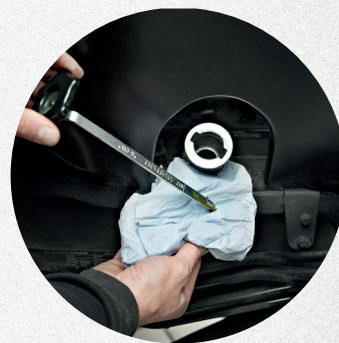
Kontrola poziomu oleju i jego uzupełnianie bez podnoszenia maski silnika.
