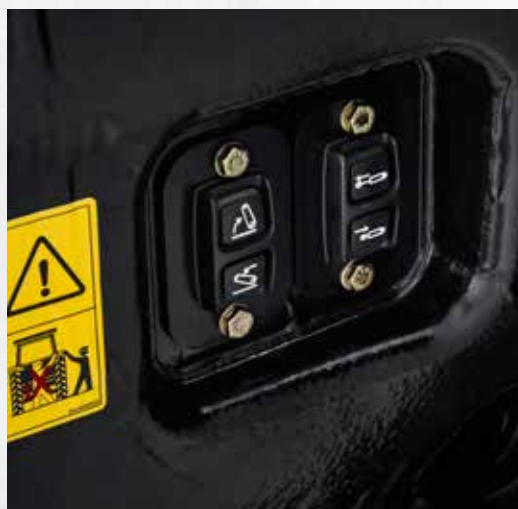
Leicht erreichbar: Die Außenbetätigung für Fronthubwerk, Frontzapfwelle und Steuergerät vorne.
