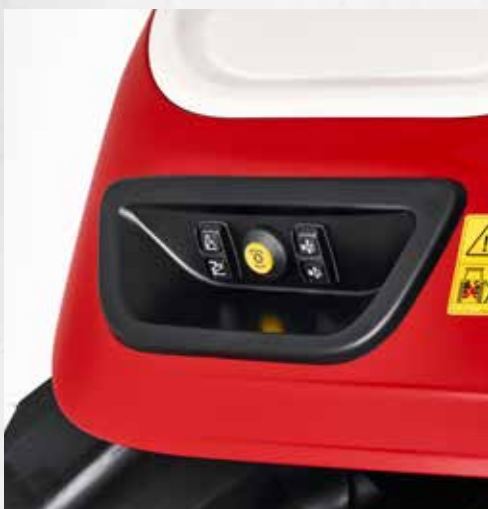
Außenbetätigung für Heckzapfwelle, Heckhubwerk und ein Steuergerät an beiden Heckkotflügeln.
