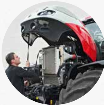
Einteilige gasdruckgefederte Motorhaube kann in zwei Positionen angehoben werden (45°/90°), sogar mit angebautem Frontanbaugerät.
