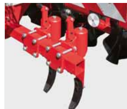
Gefederte Spurlockerer für Traktorspur
