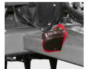
Radarsensor für Dosierung
