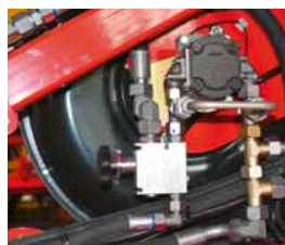
Load Sensing pro pohon ventilátoru
