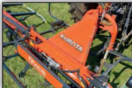
Starker und robuster V-förmiger Hauptrahmen.
