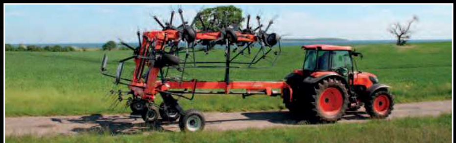
Transporthöhe ist streichen von lediglich 3,35 m sowie eine Transportbreite von unter 3,00 m erreicht.
