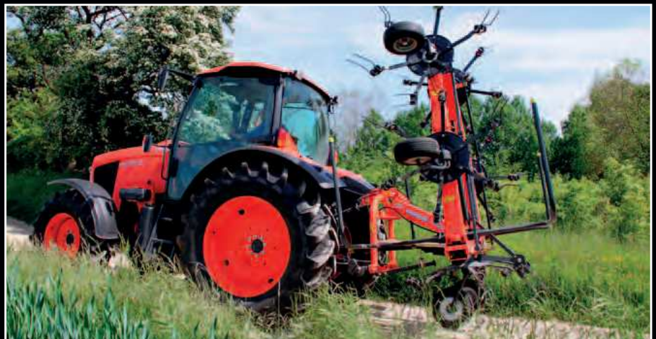
Die Kreiselzettwender werden hydraulisch mittels ew. Steuergerät von Arbeits- in Transportposition geklappt und umgekehrt.
