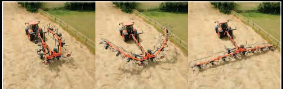
Schnelle und einfache Klappung von Transport in Arbeitsposition.
