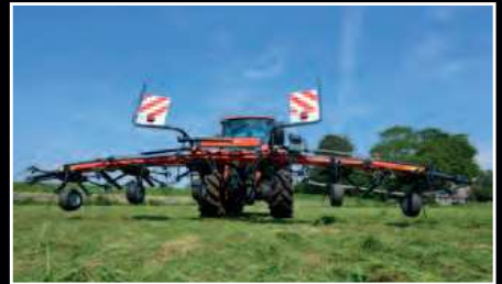
Der TE6576 kann mit dem optionalen hydraulischen Vorgewendeset ausgerüstet werden.
