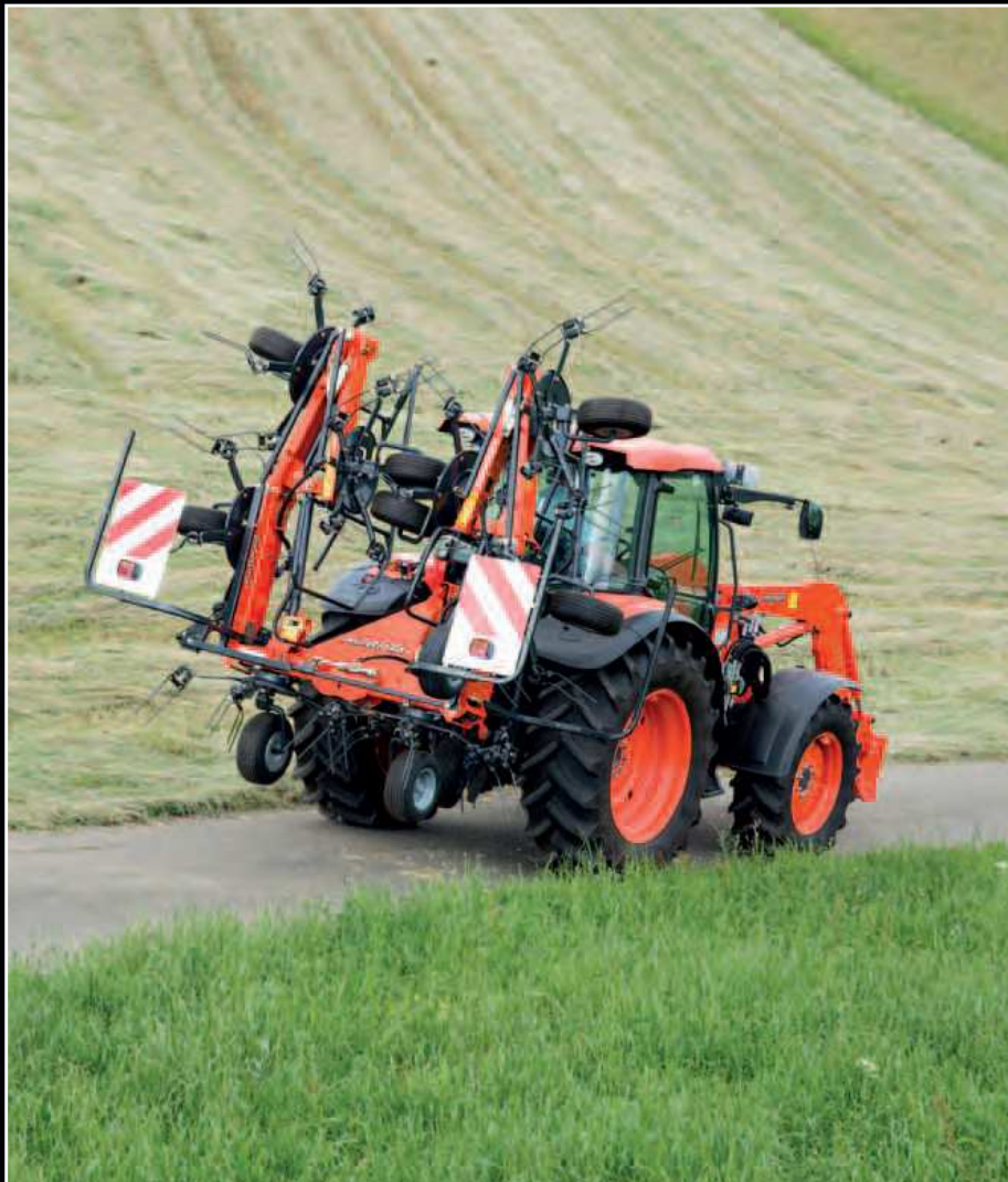
TE8080 wird in eine sehr kompakte Transportposition geklappt.
