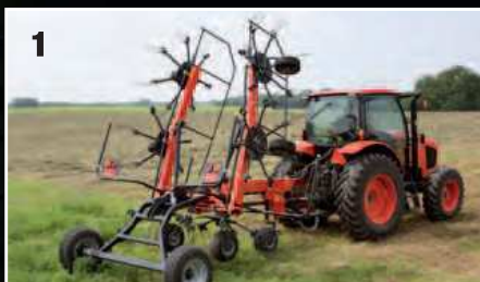
Kubota TE6576C und TE8590C können mit kleinen kompakten Schleppern eingesetzt werden.
