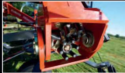
Die HexaLink Fingerkupplung erlaubt eine 180° Klappung für den Transport.
