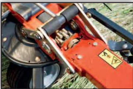
HexaLink Fingerkupplung erlaubt es, die Rotoren um 180° für den Transport zu klappen.
