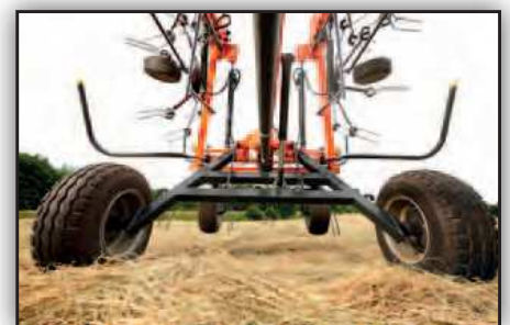
Breite Transportachse für sicheren Straßentransport.
