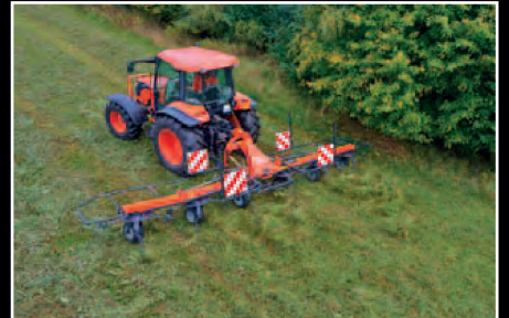
Zentrale Grenzstreueinrichtung ist bei allen Modellen Standard.
