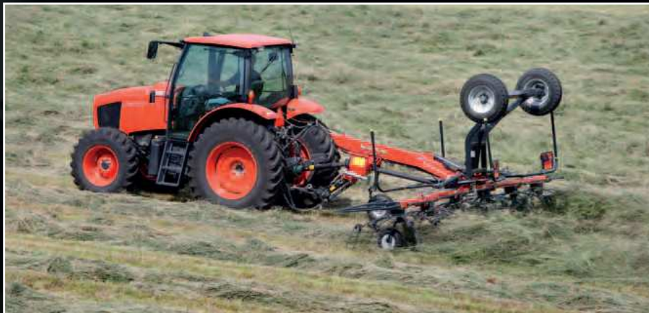
Kubota TE6576C und TE8590C können mit kleinen kompakten Schleppern eingesetzt werden.
