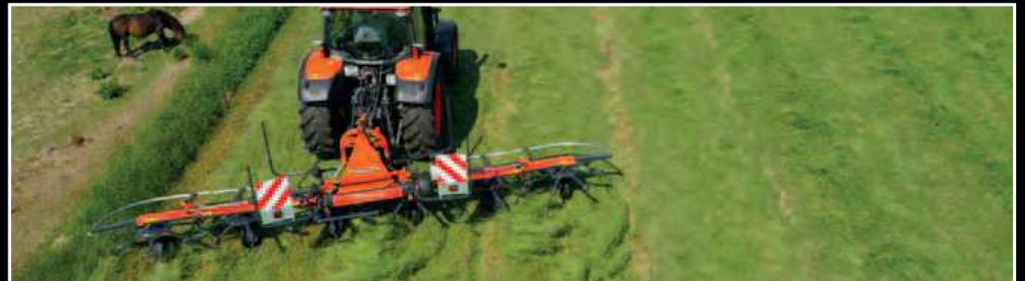
Die serienmäßig zentral einstellbare Grenzstreueinrichtung verhindert, dass Futter in angrenzende Felder geworfen wird.
