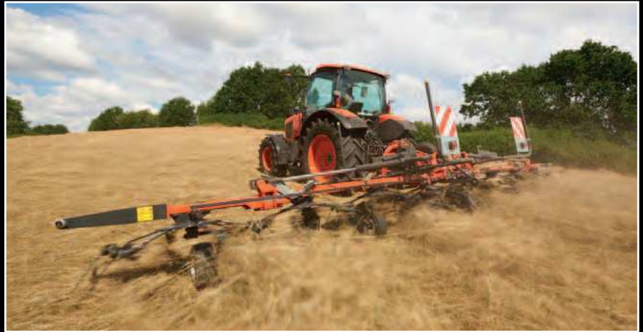
Die Kubota TE4555, TE6568 und TE8590 sind Kreiselzettwender mit Arbeitsbreiten von 5,50 bis 9,00 m.
