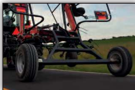
Perfekte Laufeigenschaften dank der breiten Transportachse.
