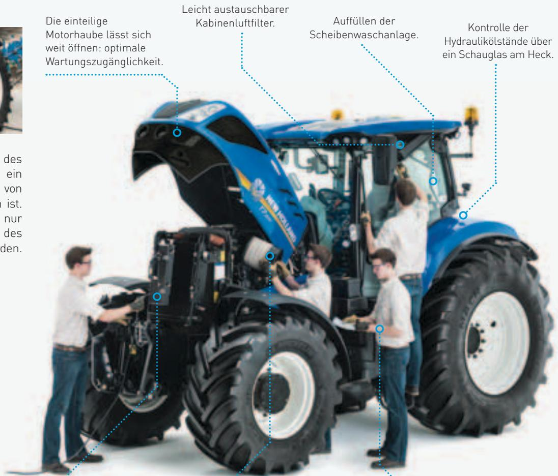
Die Kühleinheit ist zur einfacheren und schnelleren Reinigung ausschwenkbar.
