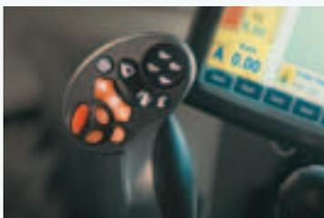
Die Softtouch-Tasten werden von hinten beleuchtet, um die Bedienung bei Dunkelheit zu erleichtern.
