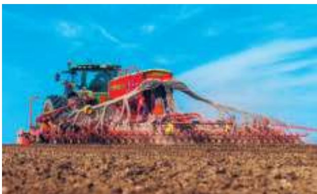
Le Spirit 600-900S permet au conducteur d'effectuer une coupe demi-semoir directement depuis son siège en cabine.
