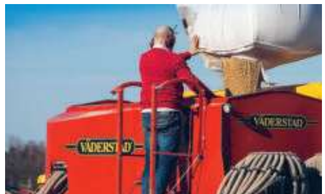
La trémie du Spirit 600-900S a une capacité de 3900 litres.
