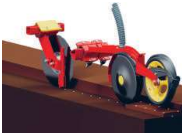
Verze Nordic ukládá hnojivo v řádkové rozteči 250 mm mezi dvěma řádky osiva a umožňuje tak neomezený přístup vlhkosti.
