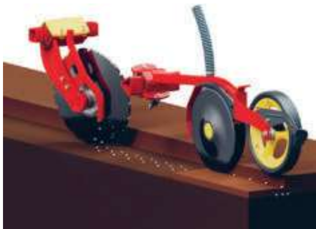
Verze FIX ukládá hnojivo v pásech šířky 5 cm v řádkové rozteči 125 mm před každým vysévaným řádkem.
