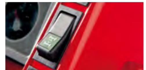
Le blocage arrière & avant des différentiels évite les glissements et optimise la traction. Le dégagement de la traction avant est utile pour les transferts sur route et élimine les dommages au sol sur les terrains délicats.
