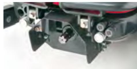
La PDF avant\* (1000 tr/min) à commande électrohydraulique à enclenchement progressif avec bouton-poussoir de sécurité ne nécessite aucun entretien.
