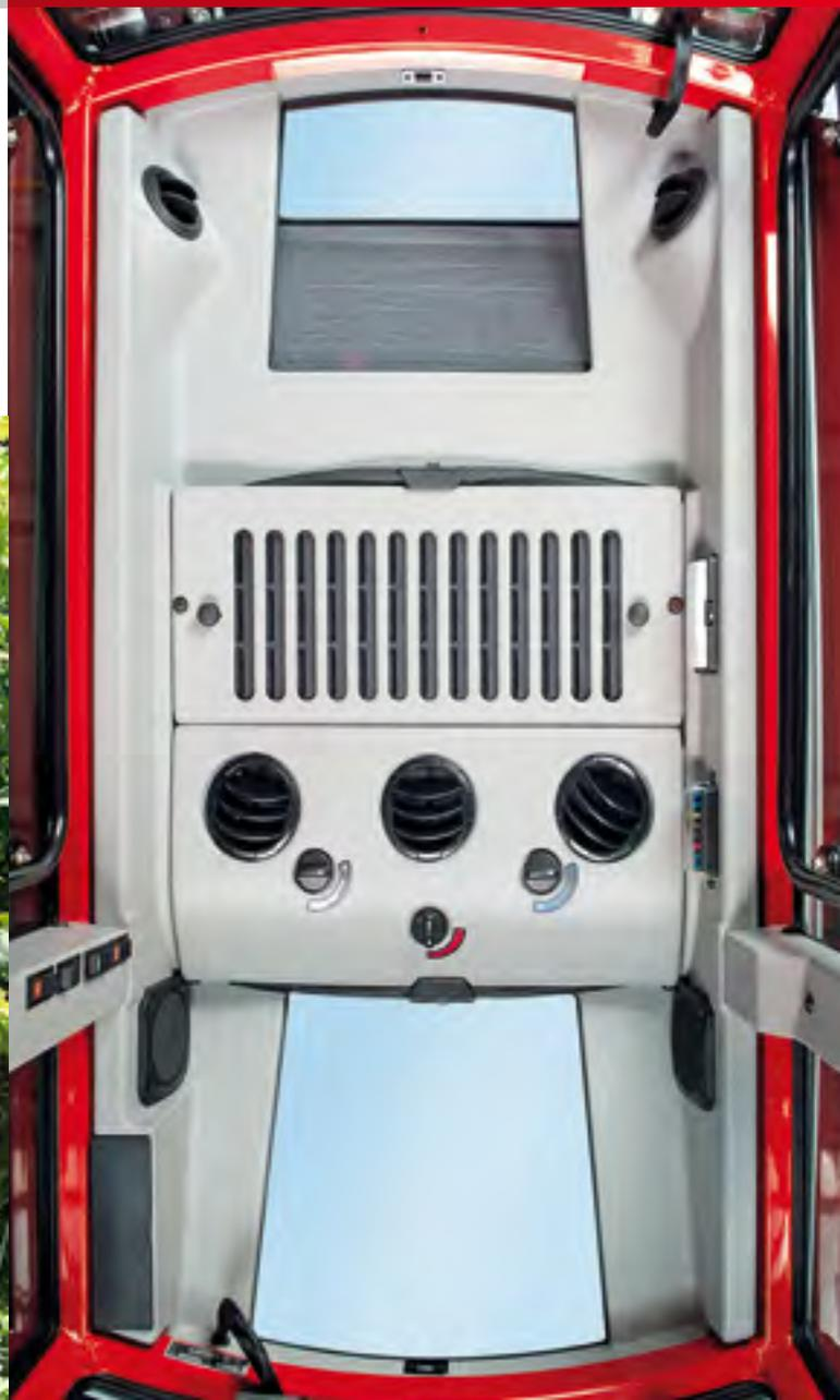
L'air conditionné de l'installation de climatisation produit un effet de pressurisation interne. L'air qui entre est dépuré par un filtre de grandes dimensions, sur demande disponible aussi à charbons actifs\*.
