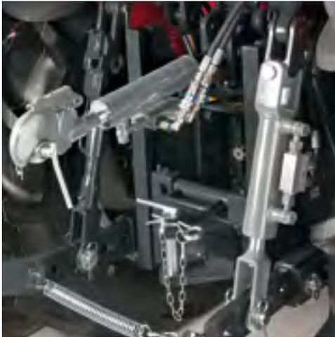
La chandelle verticale hydraulique se commande à partir du joystick\*, ce qui facilite les réglages depuis le poste de conduite.
