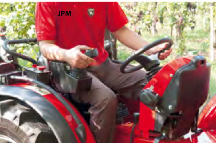
Un régulateur de descente permet de déterminer la vitesse de descente de l'équipement, sans interférer sur la vitesse de montée. Le joystick JPM™ permet de gérer une prise électrique commandée pour des équipements à fonctionnement électrique. De nombreuses fonctions, toutes à portée de main et faciles à utiliser grâce aux boutons-poussoirs de couleur disposés en séquence logique et intégrés sur le joystick.
