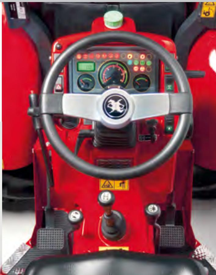
Le châssis ACTIO™ permet de faire coïncider le siège du conducteur avec le centre d'oscillation du tracteur, atténuant ainsi les secousses transversales et les cahots. De ce fait, le conducteur est bien moins fatigué même après de nombreuses heures de travail. Éléphant, le tableau de bord est fonctionnel et intuitif avec un afficheur antireflet rétro éclairé la nuit, un système d'information « on-off », un compte-tours numérique et un autre pour la PDF, des
