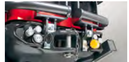
Insgesamt stehen 11 heckseitige Schnellanschlüsse zur Verfügung, von denen 6 frontseitig verdoppelt sind (Option).
