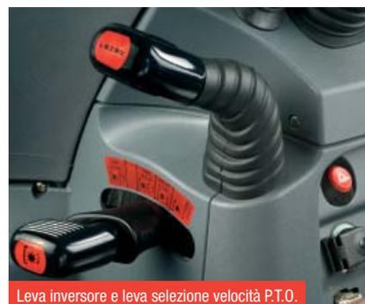
Leva inversore e leva selezione velocità P.T.O.
