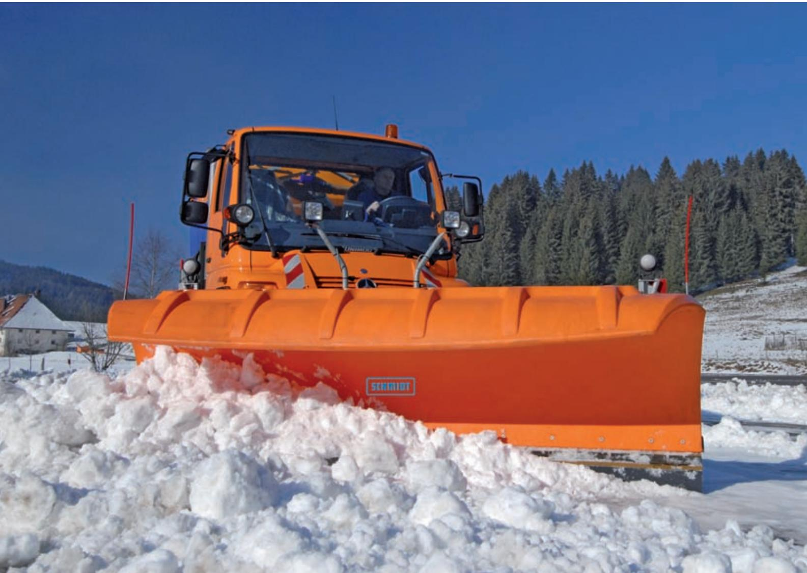
Zur Räumung von leichtem Schnee und Schneematsch in unteren Höhenlagen.
