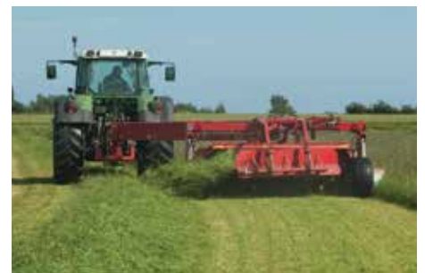
De GMT L/Flex-maaiers kunnen met de "Collector"-uitrusting worden uitgerust voor dubbele zwaden. Met deze uitrusting kunt u dubbele zwaden voor de volgende machine afleggen om de machineketen te optimaliseren.
