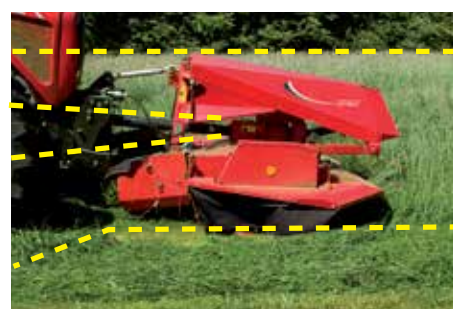
Lautaspalkki kallistuu eteen ja taakse, jolloin samansuuntaisuus pellon pinnan kanssa säilyy.
